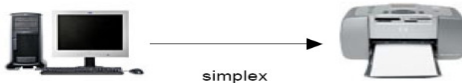
Σχήμα : Παράδειγμα επικοινωνίας simplex: Αποστολή data από Η/Υ σε εκτυπωτή.
